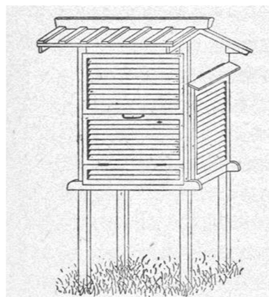
図 百葉箱 (1940年頃の日本製)「気象観測法講和」三浦栄五郎著より
